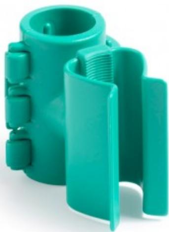
Attacco portamanico in polipropilene privo di viti, agganciabile a tutti i montanti tubolari di diametro 22 mm della gamma TTS, grazie ad un sistema di chiusura a "scatto", che consente di fissarlo sul montante in pochissimi secondi.
